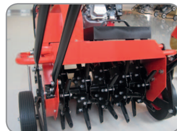
30 gehärtete Hohlzinken mit 7 cm Arbeitstiefe.
