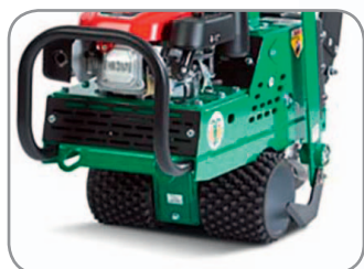
Golfwalze: Antriebswalze speziell für Golfplätze
