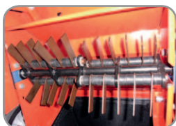
Am Fliehkraftsystem aufgehängte gehärtete 3 mm Vertikutiermesser.
