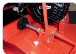
Langlebiger Messerswellenantrieb mit kugellagerter Metallspannrolle. Doppelriemen
