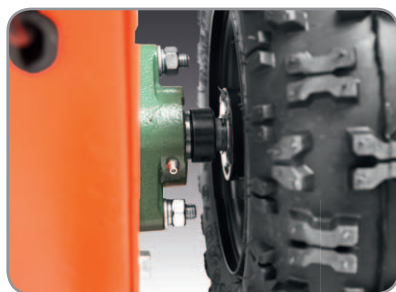
Gusseisener Lagerflansch Serienmäßig.
