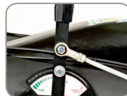
Saugleistungsregulierung mit Handhebel.
