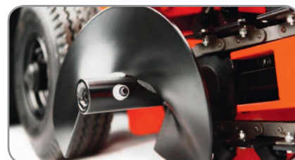
Förderschraube legt den Aushub sauber ab.
