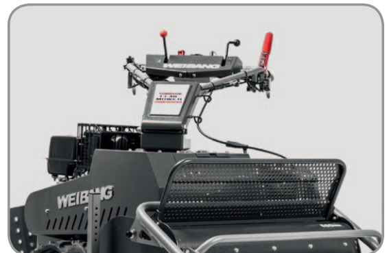
Führungsholm Seiten- und Höhenverstellbar
