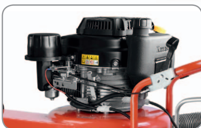
Kraftvoller OHV-Motor mit großem Tank.
