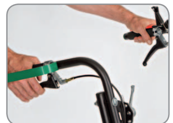
Einfachste Bedienung: linker Hebel -> rückwärts, rechter Hebel -> vorwärts. BC 2601 HHC Handschutz serienmäßig
