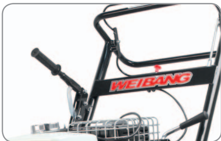
Arretieren eines Rades für relativ müheloses Fräsen.
