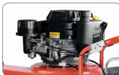
Kraftvoller OHV-Motor mit großem Tank.
