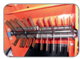
Am Fliehkraftsystem aufgehängte gehärtete 3 mm Vertikutiermesser.
