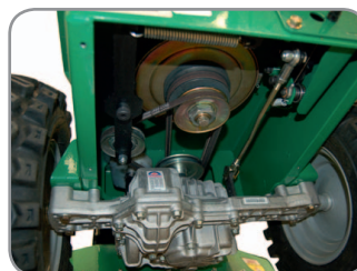
Tuff Torq® Hydrostat; eigentlich für den Antrieb von großen Aufsitzmähern geeignet. BC 2601 HHC
