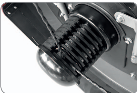
Fadenkopf mit 8 Aufnahmemöglichkeiten
