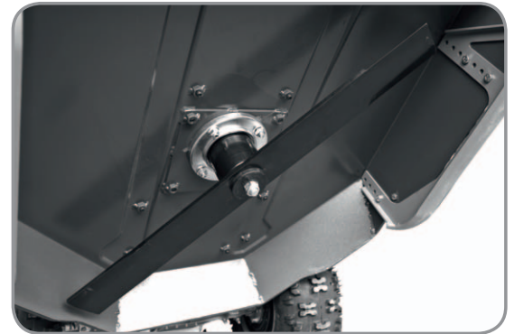
Extrem robuste Messeraufnahme und stabiles Messer
