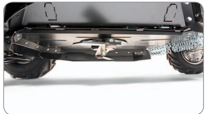
Robustes Mähwerk mit separaten Messerklingen.
