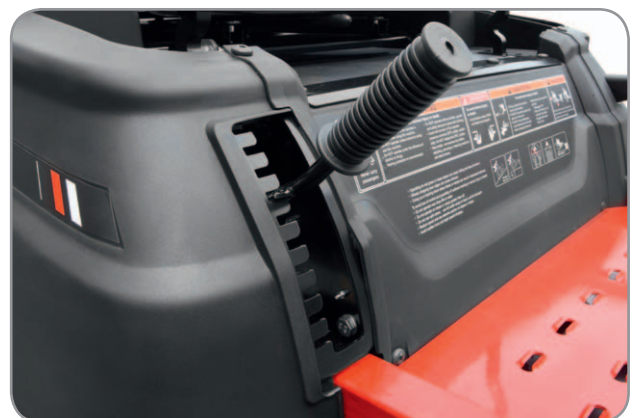
Einfach zu bedienende Schnitthöhenverstellung in zehn Stufen
