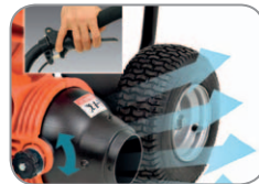
Luftauslass vom Holm aus verstellbar.
