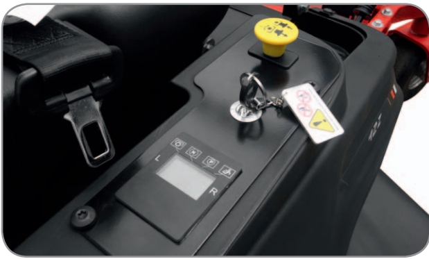
Übersichtliches Bedienfeld mit beleuchtetem LCD Display für die wichtigsten Informationen wie z.B. Akkustatus, Geschwindigkeit und Sicherheitsschaltkreise.
