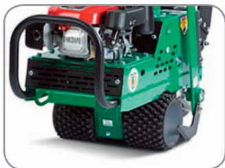
Golfwalze: Antriebswalze speziell für Golfplätze
