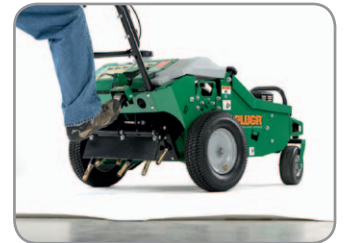
Einfaches Ausheben der Spoons per Fußraste
