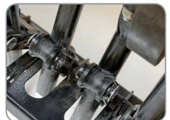
Laufbuchsenführungen für präzise Einstiche der Hohlzinken
