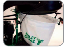
Einfaches Entleeren durch vier Schnellverschlüsse.
