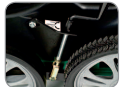
Stufenlose Höheneinstellung über Spindel.
