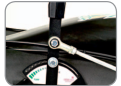
Saugleistungsregulierung mit Handhebel.
