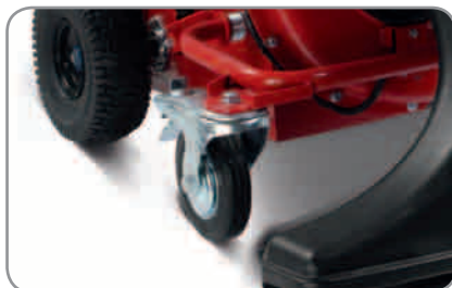
Drehbare Fronträder mit Feststellbremse
