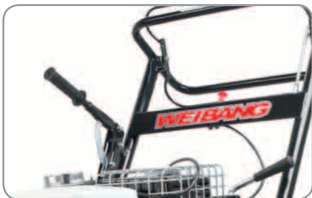
Arretieren eines Rades für relativ müheloses Fräsen.
