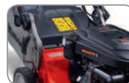
Robuste zentrale Schnitthöheneinstellung (8-fach).
