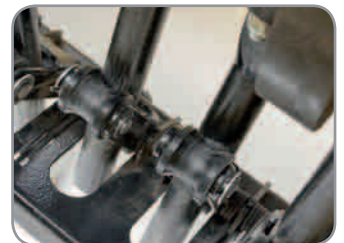
Laufbuchsenführungen für präzise Einstiche der Hohlzinken
