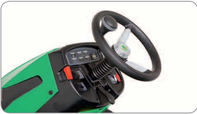
Übersichtliche Bedienelemente, höhenverstellbares Lenkrad.
