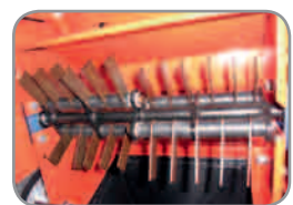
Am Fliehkraftsystem aufgehängte gehärtete 3 mm Vertikutiermesser.
