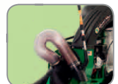
Opt. Saugschlauch (3 m) für unzugängliche Stellen.
