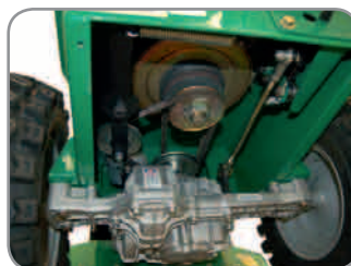
Tuff Torq® Hydrostat; eigentlich für den Antrieb von großen Aufsitzmähern geeignet. BC 2601 HHC
