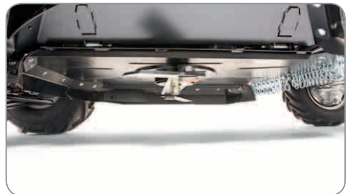
Robustes Mähwerk mit separaten Messerklingen.
