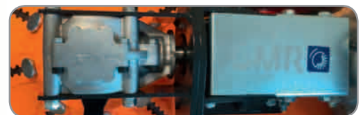
Kardanwelle mit Alu-Winkelgetriebe.
