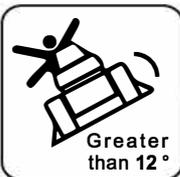
Verwenden Sie diese Maschine nicht an Hängen mit mehr als 12° Neigung.
