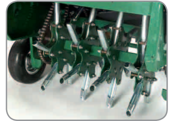
Aerifizieren mit gehärteten Hohlzinken.
