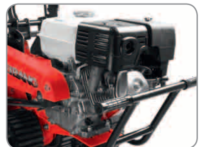
Honda OHV Industriemotor für optimale Leistung.
