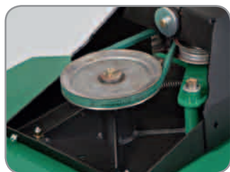
Überdimensionierter und wartungsfreier Messerantrieb
