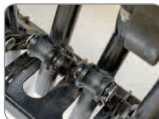
Laufbuchsenführungen für präzise Einstiche der Hohlzinken
