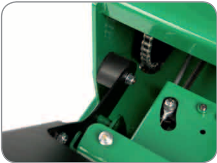
Überdimensionierte Gummilagerung des Holms für vibrationsfreies und angenehmes Arbeiten.
