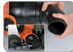
Luftaustrittsrichtungsänderung (Serie bei 10er und 13er).
