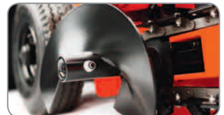
Förderschraube legt den Aushub sauber ab.
