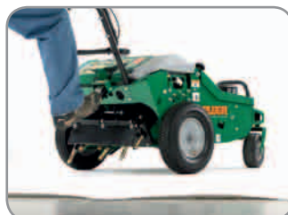
Einfaches Ausheben der Spoons per Fußraste
