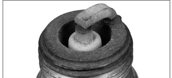
Die Zündkerze eines Motors bei Normalbetrieb hat bräunliche oder graue Ablagerungen. Falls die Mittelelektrode nicht verschlissen ist, kann der Elektrodenabstand nachjustiert und die Zündkerze wiederverwendet werden.
