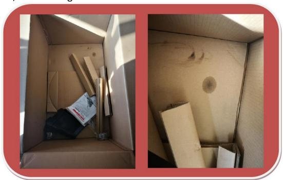
Diese Ölflecken stammen aber garantiert nicht vom Getriebe, sondern aus minimalen Leckagen des Antriebsbowdenzuges durch enorme Temperaturschwankungen während des Transportes und sind zu vernachlässigen, da keine Beeinträchtigung der Funktion besteht. Die meisten Bowdenzüge am Markt sind serienmäßig ohne Fett.
